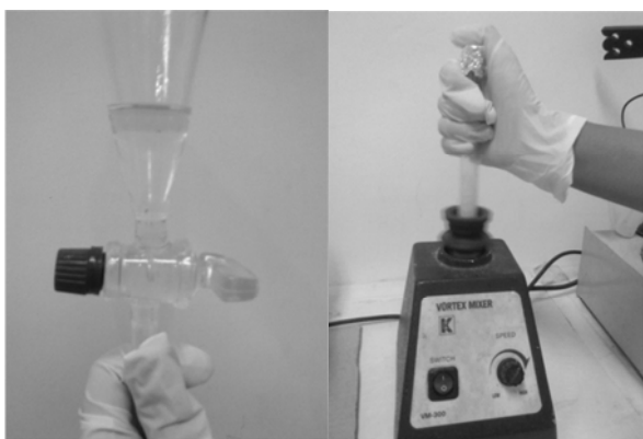
Gambar 2. Proses pemisahan ekstrak dengan rafinat.
