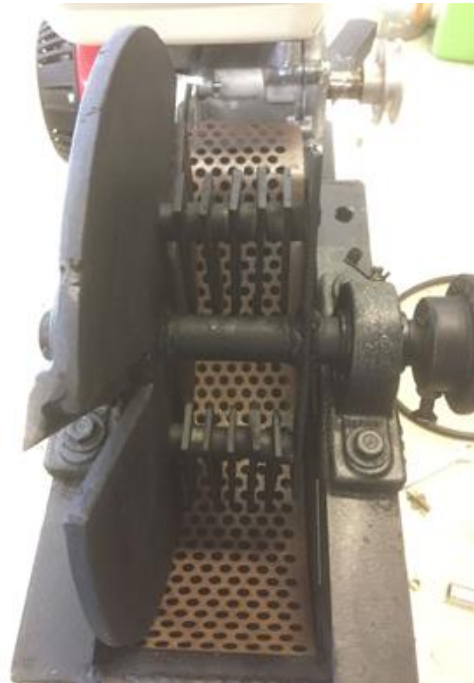
Gambar 3. Konstruksi Mekanis Komposter Elektrik
