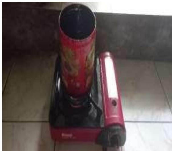
Gambar 4. Pemanasan aspal murni
