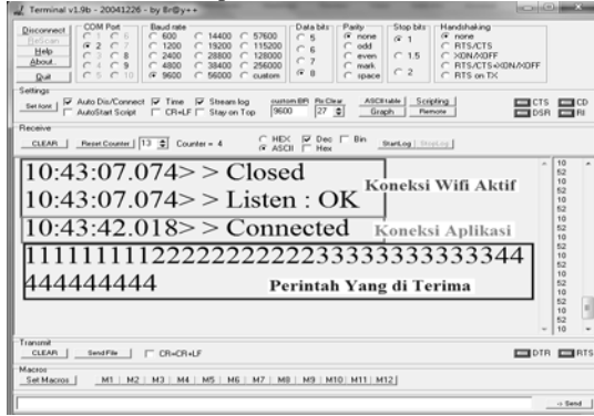
Gambar 24. Hasil perintah yang dikirim dari handphone menggunakan Software Terminal pada PC
