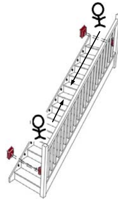
Gambar 18. Ilustrasi saat orang naik tangga dan posisi saat LED menyala dari bawah ke atas, ada orang yang turun
