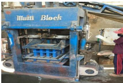
**Gambar 3.** Mesin Cetak Paving Block
