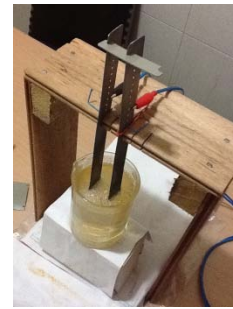
Gambar-6. Setelan kedalaman elektroda 2 mm pada jarak 20 mm
