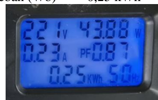
Gambar 9. Hasil pengukuran parameter pada beban dengan menggunakan energy meter
